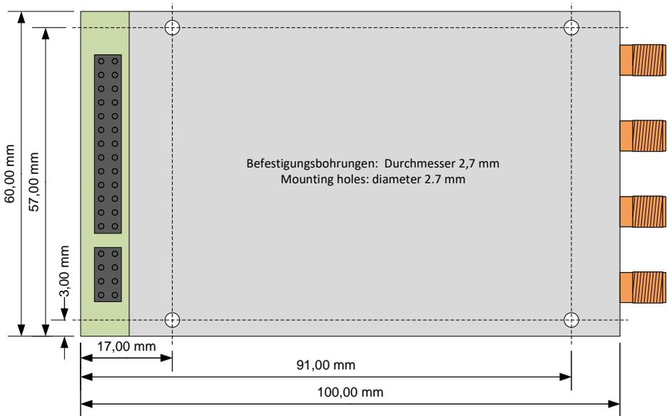
Zur Kühlung sollte die Oszillatorbaugruppe auf ein Chassisblech oder einen kleinen Kühlkörper montiert werden. Die Gehäusetemperatur darf +55 °C nicht überschreiten.
